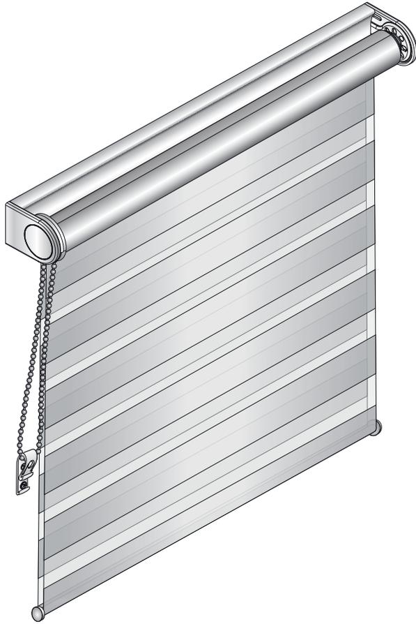
Das Twist® Doppelrollo wird fertig montiert auf einer Trägerschiene geliefert. Die Montage erfolgt mit Clip an der Wand oder an der Decke. Die Stoffbahn ist sowohl am Aluminiumrohr als auch an der Trägerschiene befestigt und rollt über den runden Unterstab auf oder ab.
