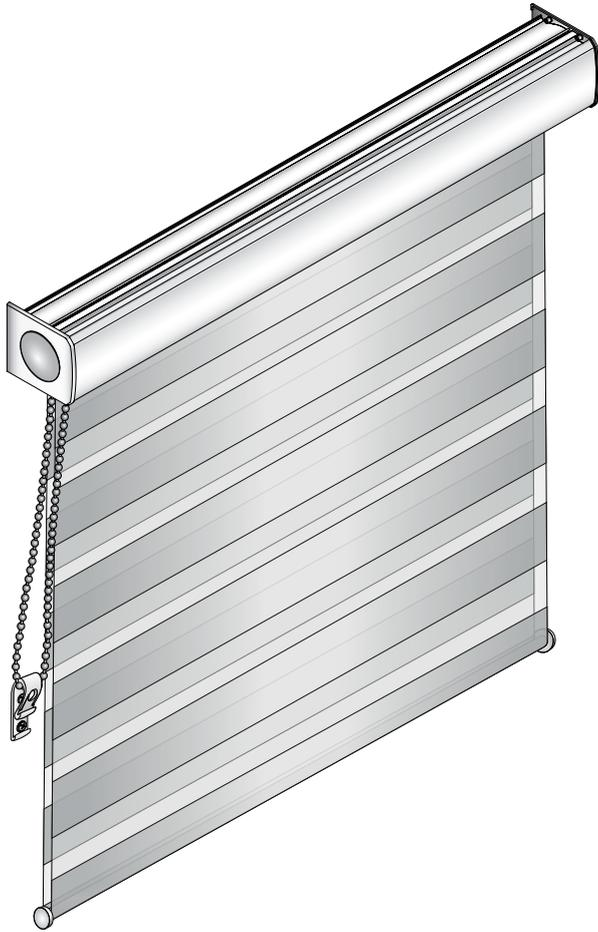
Eine hochwertige Aluminium-Kassette verdeckt beim Twist® Doppelrollo die Rollowelle. Die Montage kann an der Wand oder an der Decke erfolgen. Die Stoffbahn ist sowohl am Aluminiumrohr als auch an der Kassette befestigt und rollt über den runden Unterstab auf oder ab.
