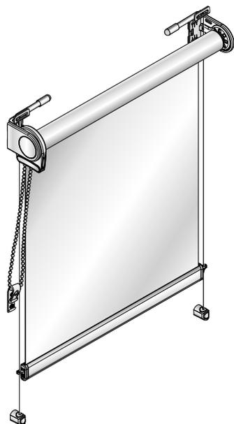
Das Luxaflex® System 8000 ist in allen Bedienungsvarianten auch mit zusätzlicher Seitenführung erhältlich (Aufpreis). Die Seitenführung verhindert Bewegungen des Behangs bei Luftzirkulation. Um einen Schiefelauf des Stoffes zu vermeiden, wird sie bei allen Rollos ab einem Breiten-/Höhenverhältnis von 1:3 empfohlen.
