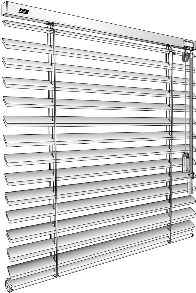
Die Luxaflex® Jalousie MegaView™ ermöglicht durch das Wenden der Lamellen eine bessere Durchsicht – eine sogenannte „doppelte Aussicht“ – nach draußen.
