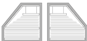
Typ BB 80 für Fünfeckfenster mit einer Schräge, schmale Breite oben
