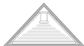
Typ BB 71 für Dreieckfenster mit zwei Schrägen, Spitze oben
