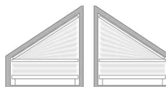
Typ BB 42 und BB 44 für Viereckfenster mit einer Schräge, Spitze oben
